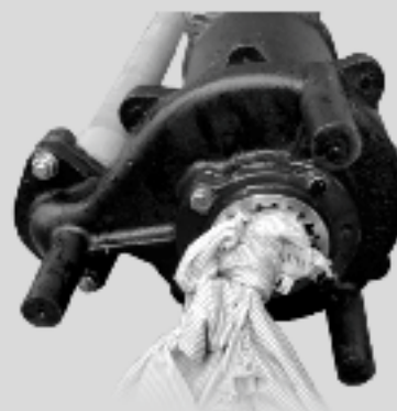
Ukázka řezacích schopností čerpadel řady GF
